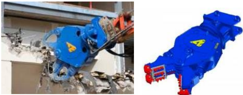
Abbildung 11: Foto und Zeichnung einer Kombiabbruchzange im Einsatz
